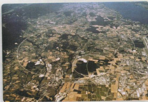
Figura A Fotografia aerea di Ginevra. La circonferenza più grande indica il tracciato dell'acceleratore LHC costruito in un tunnel a 100 m di profondità.
